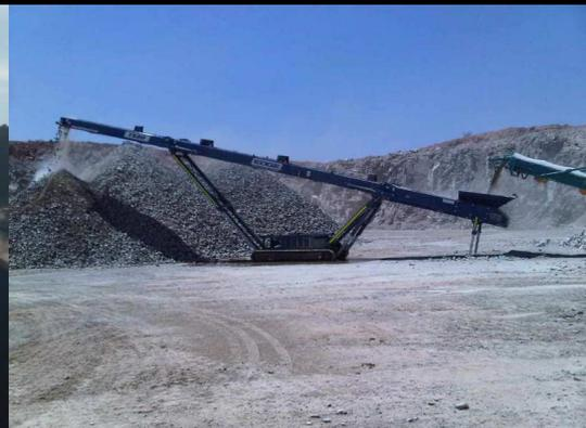
La gamme TS de convoyeurs mobiles sur chenilles EDGE, pouvant être télécommandée et associée à un concasseur, crible ou scalpeur, est la solution idéale pour réduire vos coûts de déplacements et stockages de matériaux.
