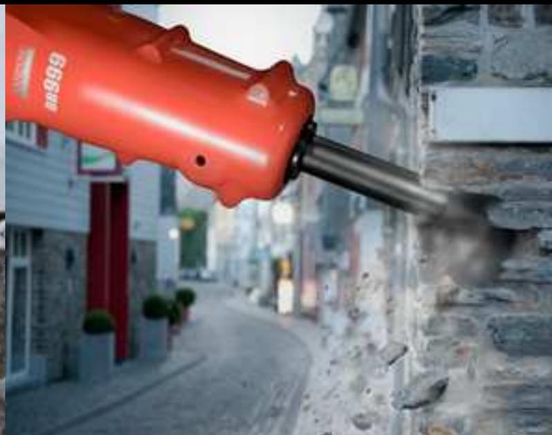
Les marteaux hydrauliques de la gamme légère de Sandvik combinent parfaitement simplicité et rentabilité. Ils sont conçus pour durer grâce aux accumulateurs de type membrane qui assurent une puissance de frappe et protègent contre les pointes de pression.
